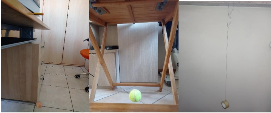
Figura 1: Immagini di pendoli fatti in casa. In ordine da sinistra con pallina di gomma, pallina da tennis e scotch.
